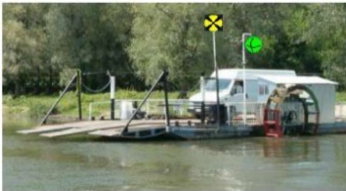
A kötel kifeszített állapotát jelzi a villogó sárga fény, a komp úton van.
