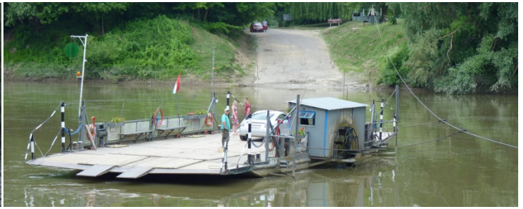
A kötel leeresztett állapotát jelzi a minden oldalról a 45 fokos szögben megdőntött rúdon a fehér zászló, a hajóút felszabadítva.
