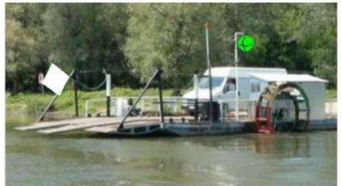
A kötel leeresztett állapotát jelzi a minden oldalról a 45 fokos szögben megdőntött rúdon a fehér zászló, a hajóút felszabadítva.
